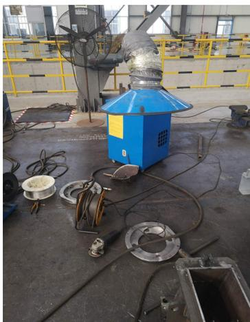
图 4-2 移动式焊烟净化器
