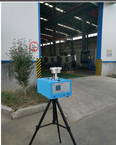
图 1 无组织废气监测
